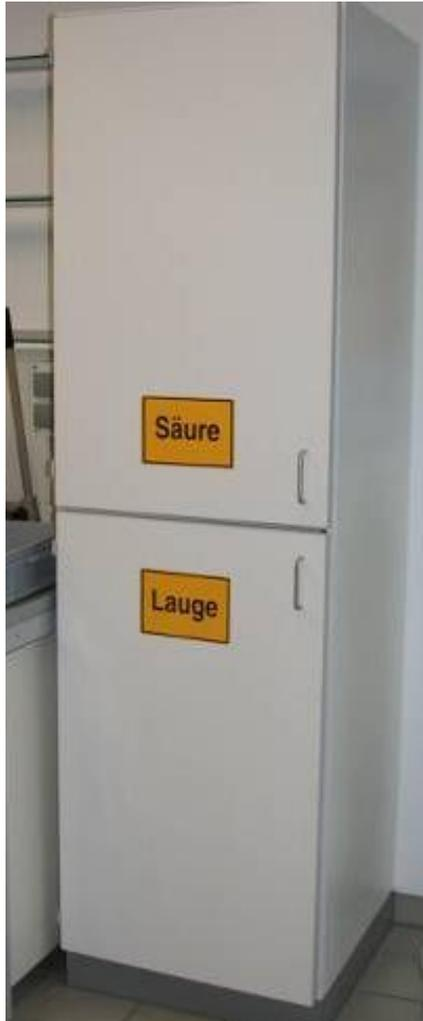
Keine Säuren und Laugen in Sicherheitsschränken für brennbare Flüssigkeiten aufbewahren! > Korrosion der Sicherheitseinrichtungen
