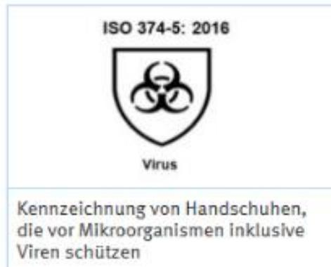
Schutzhandschuhe gegen Viren müssen hingegen nach ISO 16604, Verfahren B, geprüft werden. Der eingesetzte Bakteriophage Phi-X174 darf die Handschuhprobe nicht durchdringen.
