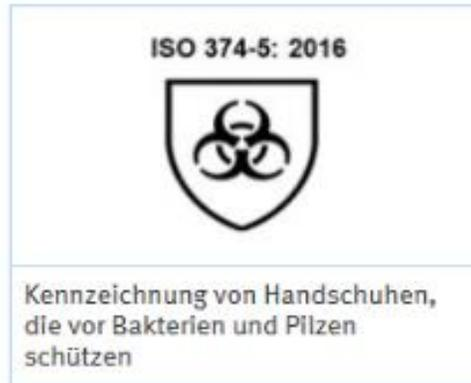
Alle Schutzhandschuhe gegen Risiken durch Mikroorganismen müssen allgemeine Anforderungen nach DIN EN 420 erfüllen. Schutzhandschuhe gegen Viren, Bakterien und Pilze müssen zudem die Penetrationsprüfung (Luft- und Wasserleck-Test) nach DIN EN 374-2 bestehen. Je ein Handschuh jeder Größe muss bei diesen Tests dicht sein.
